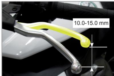
Controllare periodicamente il gioco della leva frizione e regolarlo come segue, se necessario.
