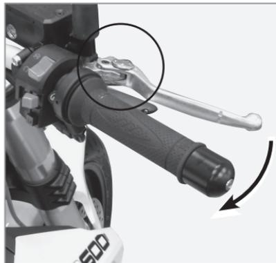
La leva del freno è munita di un pomello di regolazione "1" della posizione. Per regolare la distanza tra la leva del freno e la manopola dell'acceleratore, girare il pomello in senso orario o antiorario, ruotandolo in senso antiorario la leva si avvicina, in senso orario la leva si allontana. Accertarsi che la regolazione corretta impostata sul quadrante di regolazione sia allineata con il riferimento "2"
